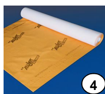
Unterdachfolie Basic 130 g/m 2 Sd-Wert ca. ≤ 0.02 m
