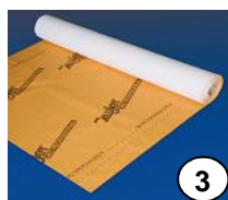
Unterdachfolie Professional 150g/m 2 Sd-Wert ca. ≤ 0.02 m
