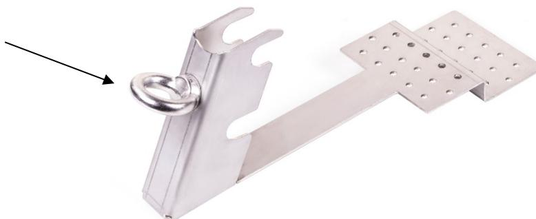
**Le SESY-19 Solo, point d'ancrage selon DIN EN 795:2012 type A, DIN CEN/TS 16415:2017 est testé pour 3 personnes. Une utilisation par la façade est exclue. Le montage s'effectue uniquement en bois. Testé et adapté pour une installation en association avec un system stop-neige tubulaire.**
